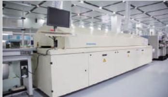
全热风氮气回流焊炉
