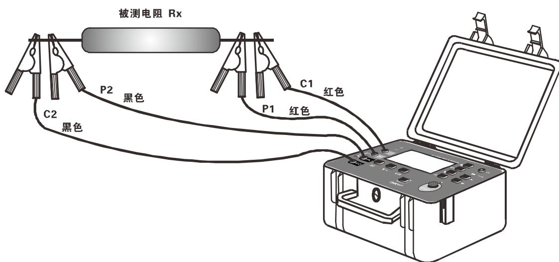
下图图例，测试电表箱与接地与下线之间的等电位电阻值。
