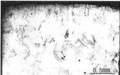
图 1 一次短路的铜导线显微组织
