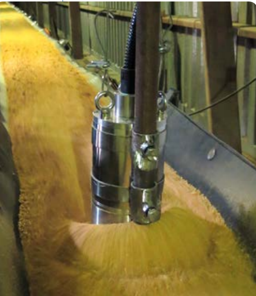
非接触式发射探头安装在传送带之上，对豆粕进行连续分析。
