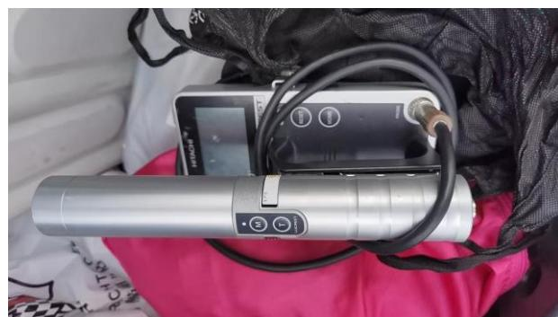
图 3-3.7 便携式 X-γ 剂量率仪
