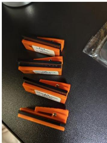
图 3-3.5 个人剂量计实物图
