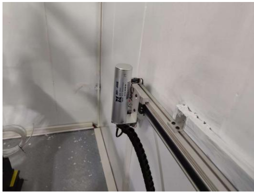
图 3-3.7 固定式辐射探测装置探头
