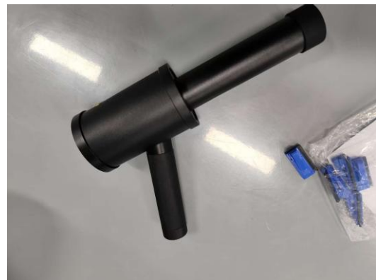
图 3-3.10 便携式 X-γ 剂量率仪
