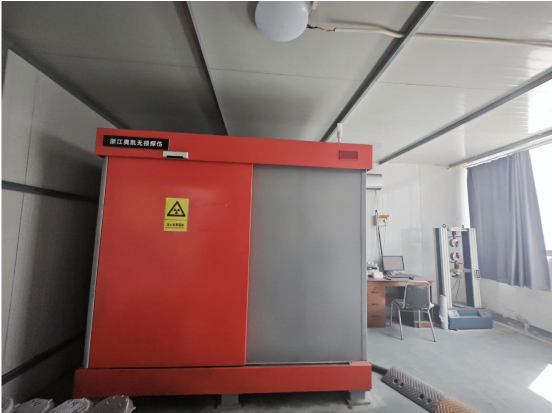
图2-4 FSX-T200-P4343D C型臂式旋转柜式 X射线实时成像检测系统外观图
