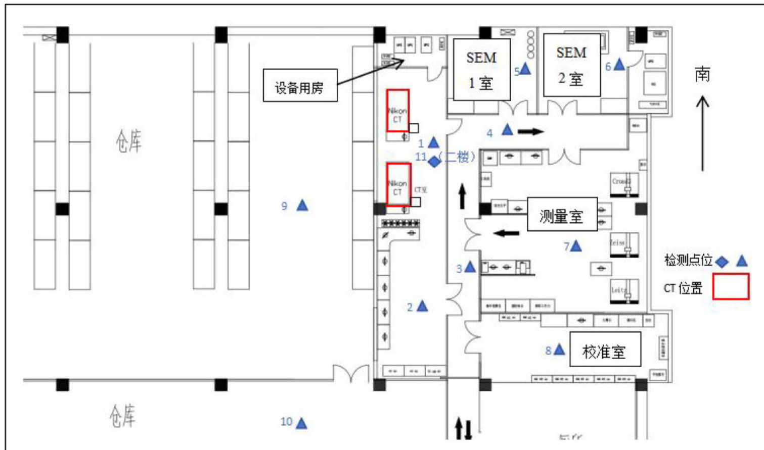
图 8-1 拟建工业 CT 工作场所辐射本底监测点位示意图
