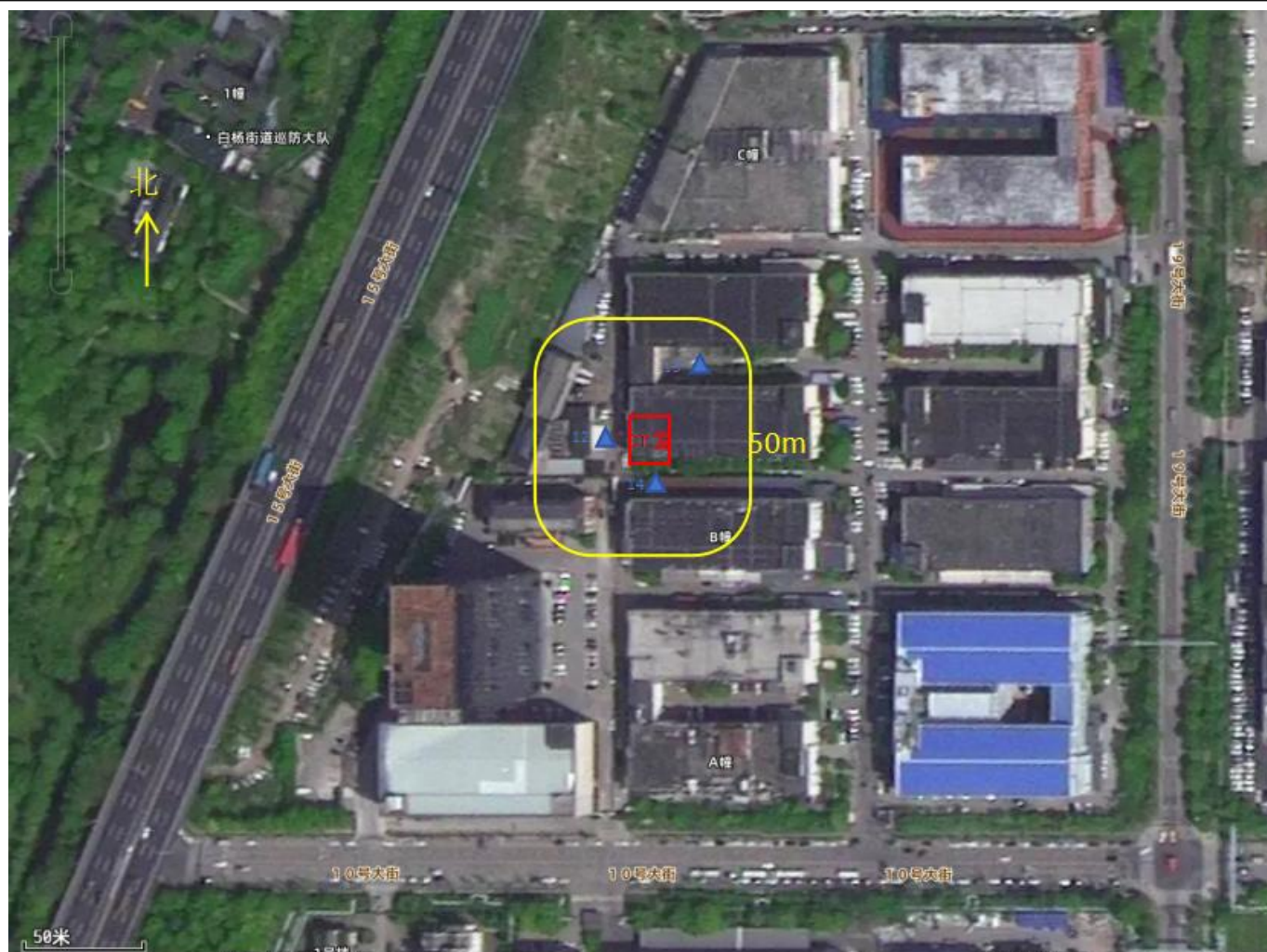
图 8-2 拟建工业 CT 工作场所周围环境辐射本底监测点位示意图
