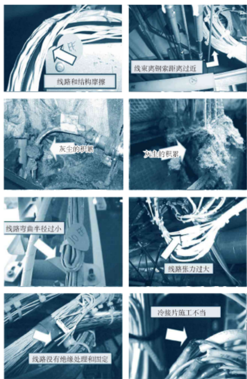
图1 导致飞机线路老化的各种原因
