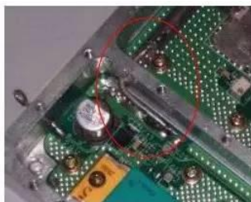
功放板板内信号用飞线连接
