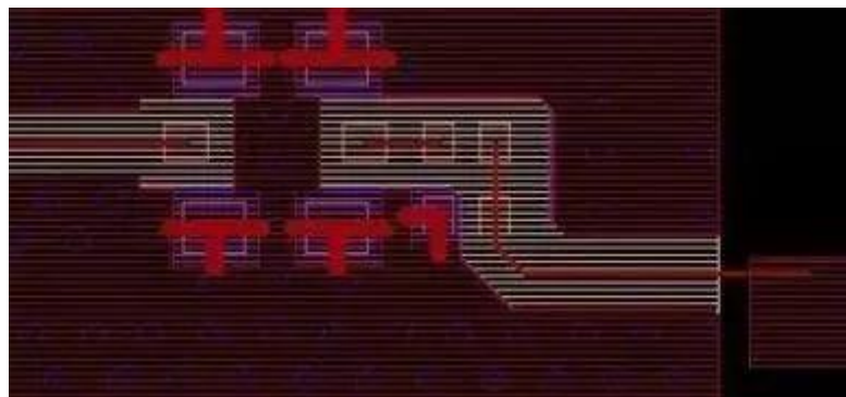
图 3a: 0.1016 mm 的射频线(表层铺地)
