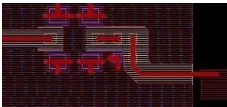
图 3b: 0.35 mm 的射频线(表层铺地)
