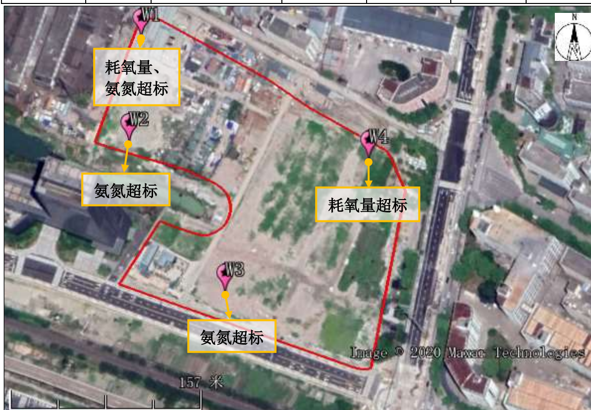
图 6.5 - 1 调查地块超标地下水监测井分布示意图
