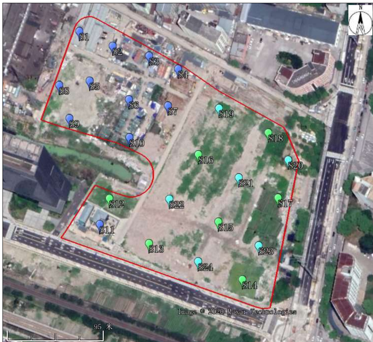
图 4.1-3 调查地块红线范围内土壤采样点位布设示意图（计划）
